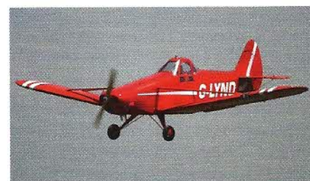
Exemple type d'un avion qui vole avec une allure queue haute : le fuselage est conçu pour donner une visibilité maximum au pilote et bien dégager le stab du sillage de l'aile... et des produits pulvérisés. L'incidence est portant tout à fait «normale».
