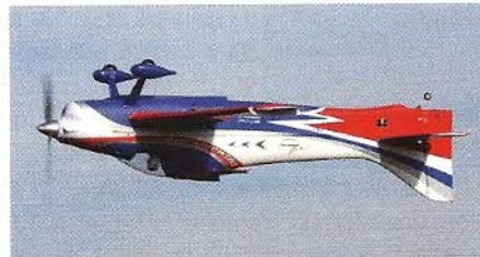
Les «Multis» de voltige type F3A modernes ont un calage faible et un fuselage dessiné pour qu'il semble parfaitement horizontal sur le ventre comme sur le dos.
